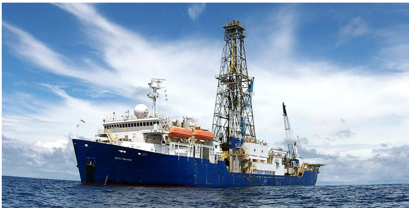
Figura 1 – O Navio Joides Resolution, laboratório flutuante que tem a capacidade de embarcar até 30 pesquisadores e perfurar em lâmina de água de 35-5980 m e furo de até 2111 m.
