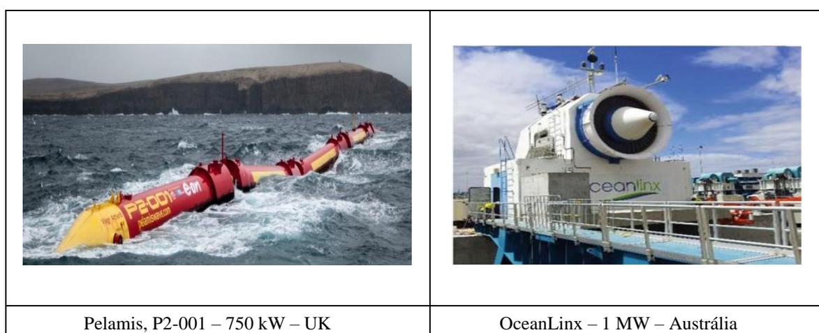
FIGURA 1: PROTÓTIPOS DE CONVERSORES DE ENERGIA DAS ONDAS EM ELETRICIDADE
