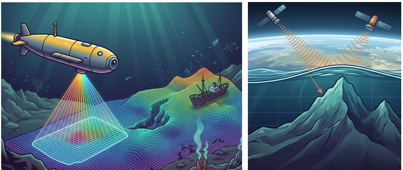
Figura 4 - A) À esquerda, o uso de Veículos Autônomos Submarinos (AUVs) equipados com sonares multifeixe para a criação de modelos digitais detalhados do relevo oceânico. B) À direita, a representação da altimetria por satélite, técnica essencial para mapear grandes áreas oceânicas e identificar montes submarinos através das variações na superfície do mar.
