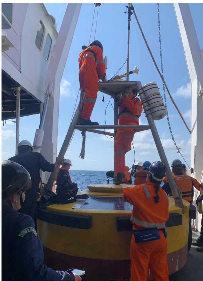
Figura 3 - Equipe técnica realizando a manutenção e calibração de boia oceanográfica para monitoramento de dados meteoceanográficos.
