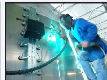
Figura 4 - Operação em curso da soldagem automática do casco do veleiro, com o robô Tartilope, utilizando tecnologia desenvolvida no LabSolda UFSC.
