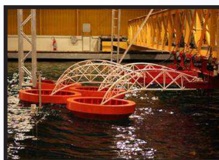
Testes de equipamentos de estruturas oceânicas e costeiras, como sistemas de extração de energia das ondas do mar.
