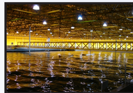
Modelação de condições ambientais do ambiente offshore, com vento, ondas e correnteza.
