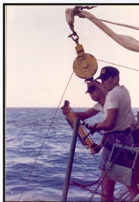
Coleta de amostra de água e medida de temperaturas utilizando garrafas de Nansen
