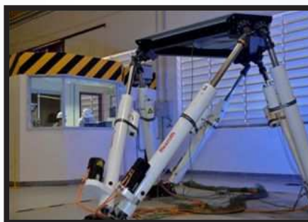
Plataforma inercial com 6 graus de liberdade para testes dinâmicos, como sloshing em navios LNG (para transporte de gás natural liquefeito).
