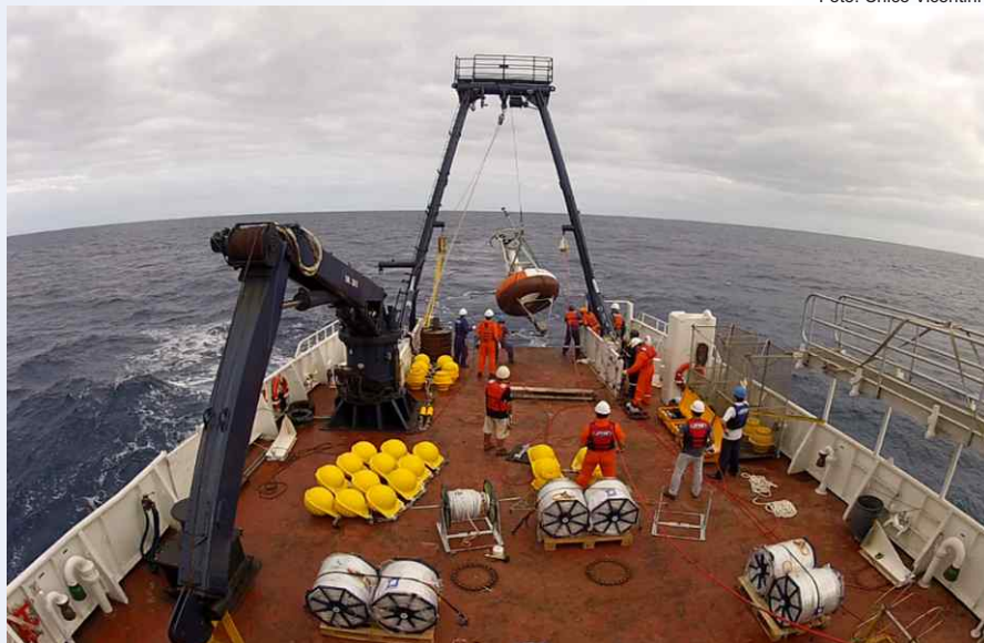
O navio Alpha Crucis conta com guinchos eletromecânico e de pesca/geologia, arco de popa com capacidade para dez toneladas.
